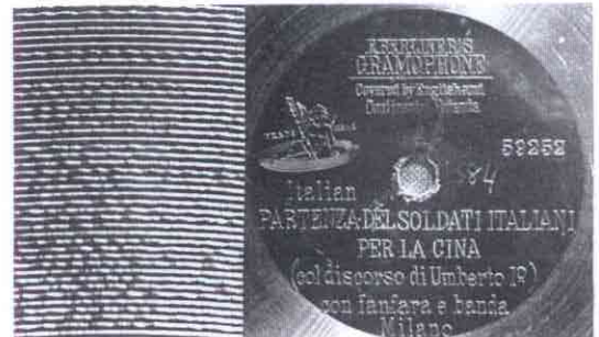
2. Berliner Platte in Seitenschrift. Abtastung durch Metallnadel. Durchmesser 18 cm, 84 U/min. Anfang der Aufnahme am äusseren Rand. Die abgebildete Platte ist vom August 1900 und enthält die Ansprache von König Umberto I an seine Soldaten vor deren Verschiffung nach China.
