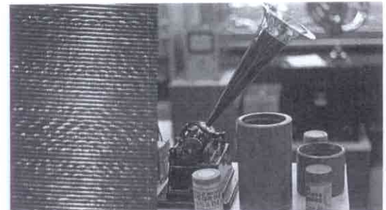
3. Edison Walze im grösseren Format, wie sie von Columbia und Pathé verwendet wurde. Aufzeichnung in Tiefschrift und Abtastung mit Saphirkugel. 160 U/min.
