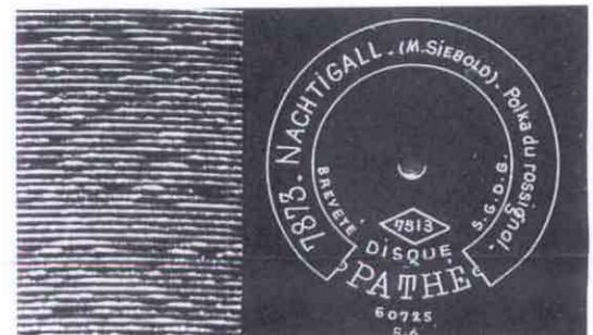
4. Pathé Platte in Tiefschrift. Abtastung mittels Saphirkugel auf der Nadel. Aufzeichnung von Innen nach Aussen. 80 – 110 U/min. bei Durchmessern von 23 – 43 cm (eine 43 Platte wog 4 kg)
